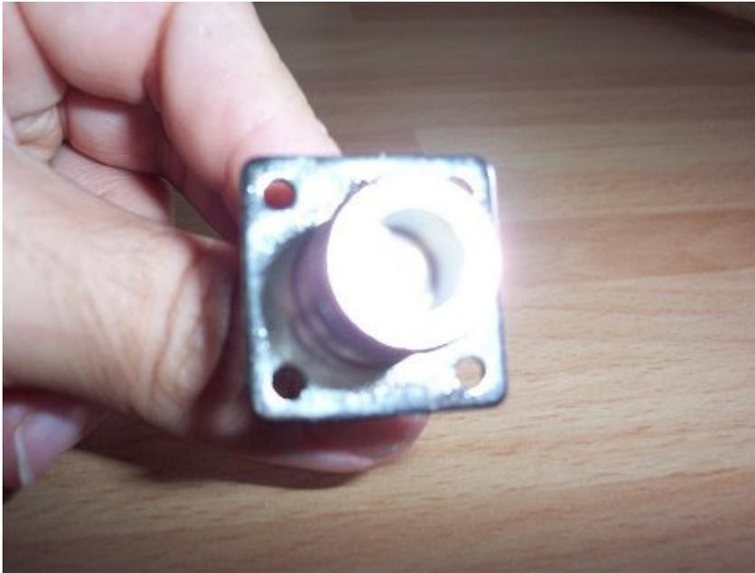
Per realizzare l'antennino, inserite uno dei chiodini all'interno del pirulino del connettore ed effettuate una buona saldatura.
