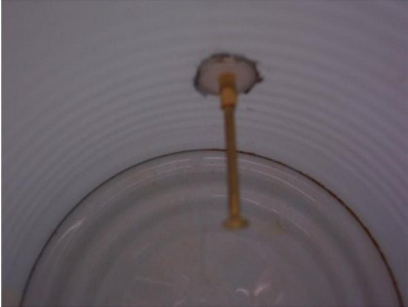
E' arrivato il momento di procurarci le viti filettate per fissare il connettore al barattolo, che dovranno essere da 3mm di diametro e 10mm di lunghezza
