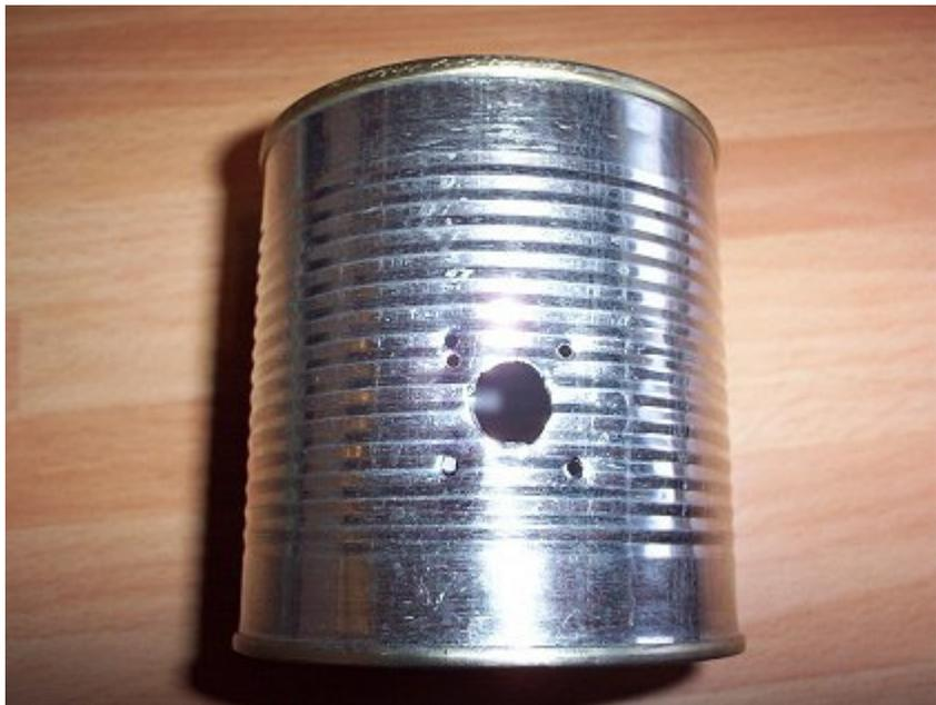
Successivamente con un trapano ed una punta per ferro da 3mm allargate i 4 fori alla giusta misura
